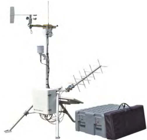
Figure 7-4 : Exemple de station météo portable pleine grandeur transmettant des données par télémétrie
