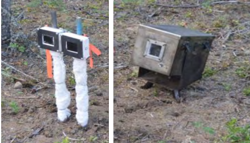
Figure 7-3 : Caméra vidéo couleur isolée (à droite) associée à deux fluxmètres thermiques (à gauche)
